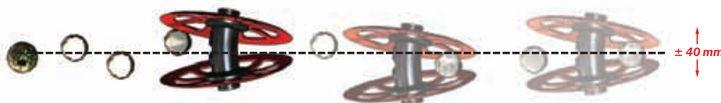
Automatische zijdelingse aanpassing ( \pm 40 mm) en hydraulisch aangedreven rooiwielen voor optimale opname van de bieten ook bij bieten die niet nauwkeurig op rij staan
