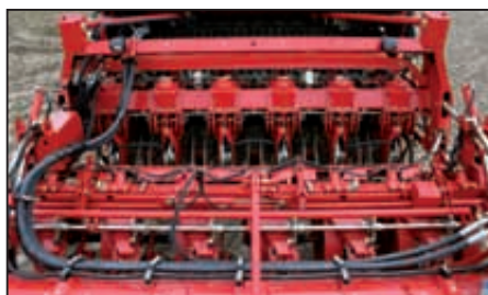
Flexibel en comfortabel: de hydraulische rijafstand-verstelling (optie)
