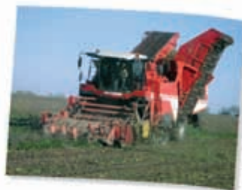
Onkruidproblemen in Rusland: Voor de combinatie van de ontbladeraar met zijafvoerband en hydraulisch aangedreven koppers geeft dit geen probleem.
