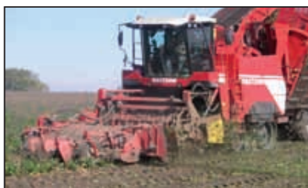
Een sterk alternatief bij het oogsten van percelen met zeer veel onkruiden: een ontbladeraar met zijafvoer (optie)
