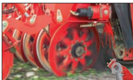
Een zuivere zaak: De hydraulisch aangedreven rooiwielen lichten de bieten uitermate productvriendelijk uit de grond.
